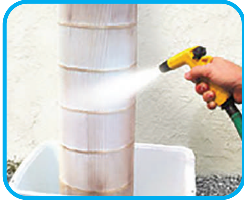
شكل يوضح كيفية غسيل المرشح الشبكي (Screen Filter)
