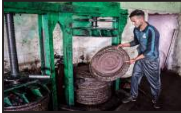
مكبس ضغط هيدروليكي باستخدام الابراش
