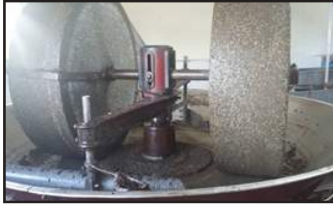
الطحن والجرش باستخدام ماتور كهربى لتحريك الاحجار
