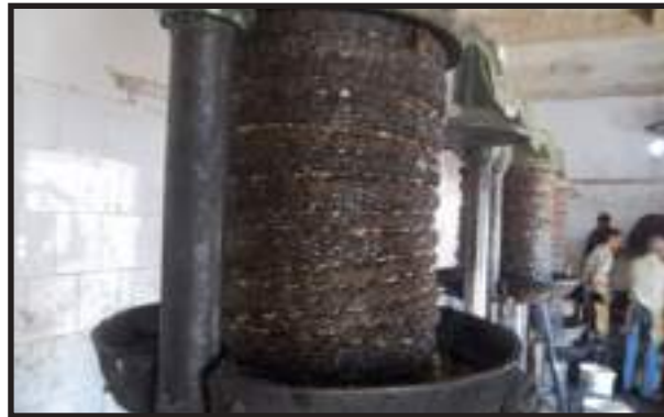
مكبس ضغط هيدروليكي باستخدام الابراش
